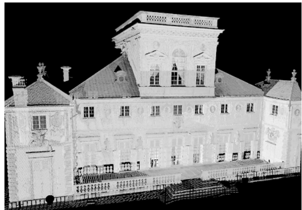
Ryc. 4. Pałac w Wilanowie, woj. mazowieckie. Widok zewnętrzny skanowanej laserowo elewacji
