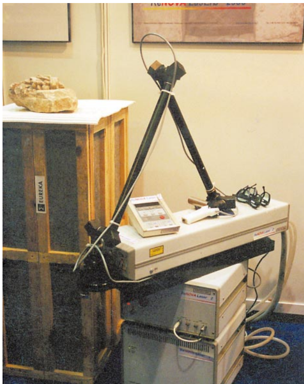
Urządzenie laserowe stosowane do czyszczenia powierzchni dekoracji kamiennej w kaplicy Zygmuntońskiej
