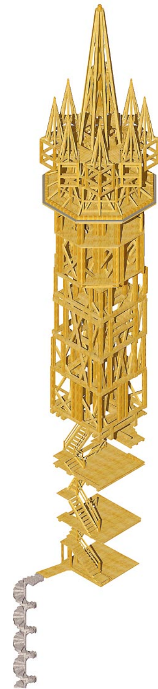
Ryc. 4. Kraków, kościół Mariacki. Model przestrzenny konstrukcji ciesielskiej we wnętrzu wieży wyższej. U dołu po lewej stopnie wieżyczki schodowej (oprac. J. Węclawowicz) Fig 4. Kraków, St. Mary's Church. Spatial model of carpentry construction inside the taller tower. Bottom left side – steps of the staircase turret (made by J. Węclawowicz)
