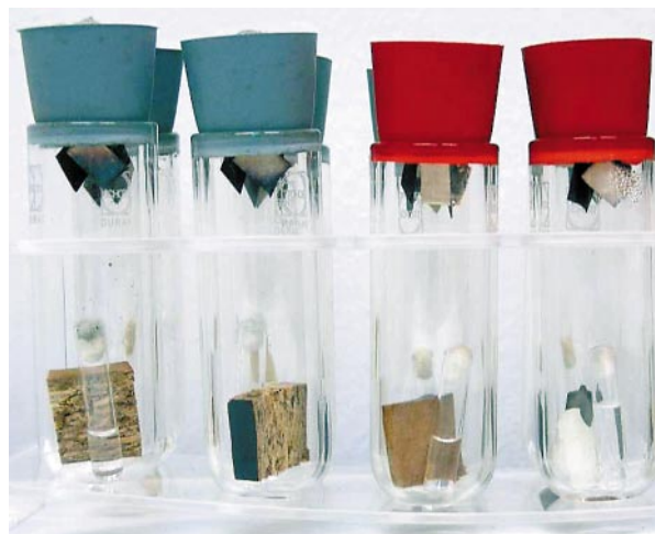
Ryc. 5. Zestaw do przeprowadzania testów Oddya na materiałach stosowanych do budowy ram mikroklimatycznych w MNK Fig. 5. A set for conducting Oddy tests on materials used for building microclimatic frames in MNK
