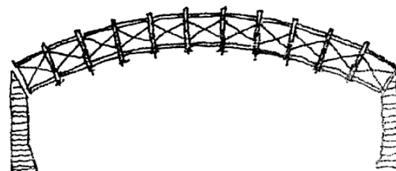
Ryc. 4. Andrea Pallado, schemat konstrukcji mostu nad rzeką Cismone z 1570 roku. Łukowe przęsła wzmocnione układem steżeń, [3] Fig. 4. Andrea Pallado, schematic of bridge over Cismone River, dating back to 1570. Arch spans reinforced with system of bracings [3]
