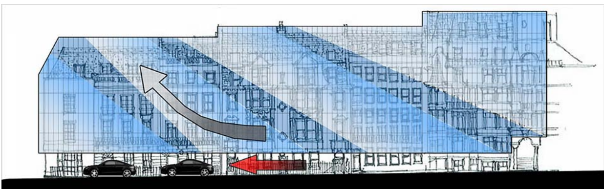
Ryc. 5. Ukształtowanie powierzchni szklanej fasady w skali ulicy. Wytworzenie prowadnic odprowadzających zanieczyszczenia ponad dachy budynków siłą pędu powietrza ruchu ulicznego (opr. Ł. Wesółowski)
