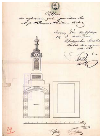
Ryc. 6. Projekt grobu Floryana Leihera z 1858 roku autorstwa Gallego ukazujący formę pomnika nagrobnego, jak również typowe w tym czasie kolebkowe (łukowe) sklepienie wykonanej z cegły piwnicy grobowcowej Fig. 6. Project of Floryan Leihera's grave from 1858, designed by Gallego, showing the form of a tombstone and a barrel (arch) vault of the tomb cellar made from brick, typical for the time
