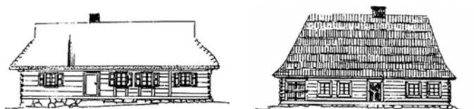
Ryc. 1. Karczma z Sochocina (XVIII w.) z konstrukcją ścian sumikowo-łątkową i chałupa z Rębowa (1875 r.) z konstrukcją zrębową ścian
