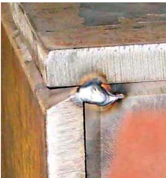
Ryc. 24. Ukosowanie krawędzi blach Fig. 24. Beveled edges of plates
