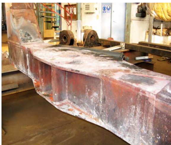
Ryc. 28. Widok jarzma po odprężeniu Fig. 28. Yoke after annealing
