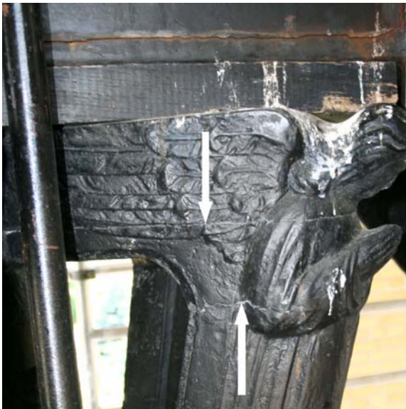
Ryc. 3. Poziome rozwarstwienia w ramionach korony dzwonu Fig. 3. Horizontal delamination in bell crown ears
