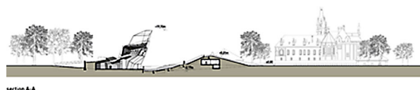
Ryc. 4. Przekrój przez teren obrazujący wpisanie nowej formy teatru w historyczne otoczenie. Źródło: https://www.dezeen.com/2009/07/14/cloud-tower-by-the-next-enterprise-architects/ , dostęp: 11.2018
